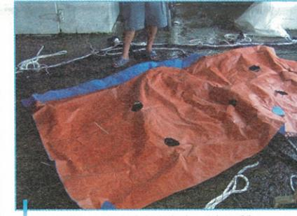
網具設備，吊網須有襯墊帆布，避免受傷
