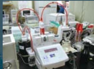
▲圖5. 估算海水  $\text{PCO}_2$  的方式之一為測定其總二氧化碳含量後，配合水樣的溫度、鹽度、營養鹽以及總鹼度等去估算樣品中的分壓。照片中的儀器為本館的總鹼度滴定儀。
