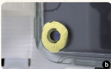
【圖2】運用黏土將透鏡固定於鏡頭前。圖(a)可見相機鏡頭與透鏡直徑均為 7 mm；圖(b)固定透鏡後，注意透鏡要對準鏡頭。
