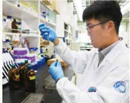
研究人員正在用有機溶液萃取共生藻脂質。
