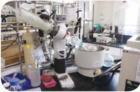
減壓濃縮機：降低大氣壓力至接近真空狀態，以排除實驗過程中的有機溶劑。
