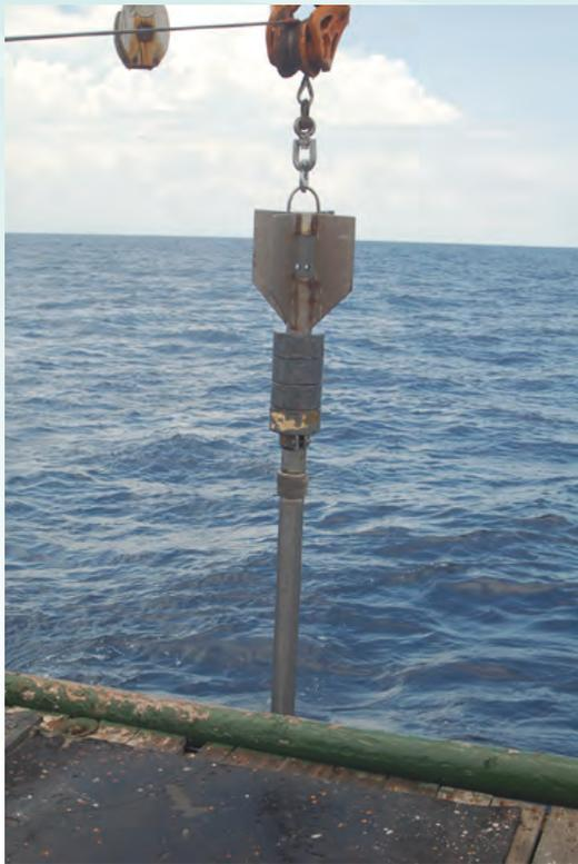
▲使用柱狀採樣器採集海底沈積物以研究海底深層生物圈。(黃永森攝)
